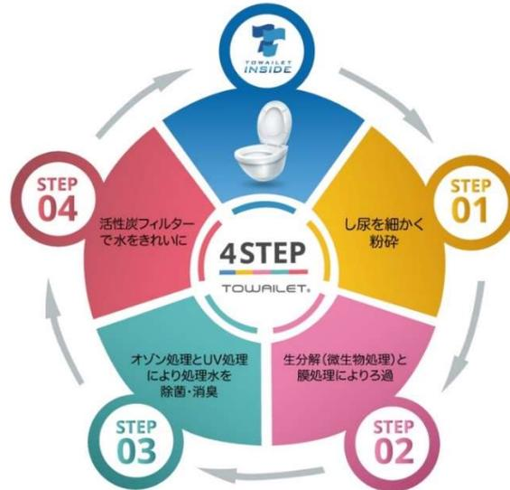
図 100. 浄化処理の概要図
