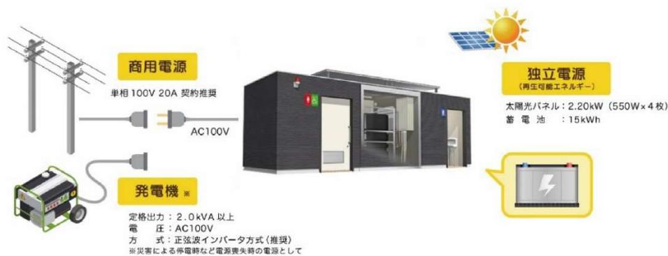
図 102. 電気設備の概要図
