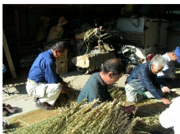
写真 さしわらつくり
