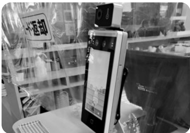
学校に設置されるサーモカメラ
